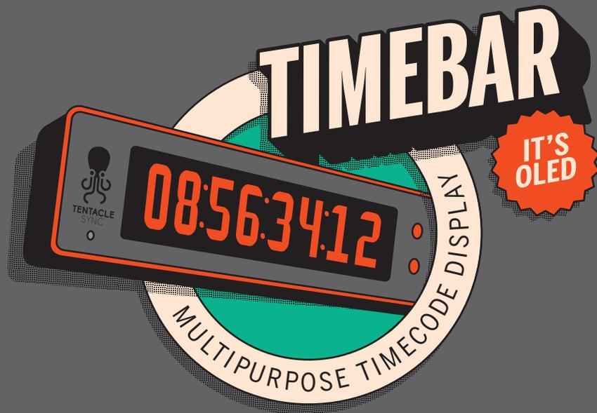
DIE **TIMEBAR** ist ein leichtes und vielseitiges Timecode-Display mit kontrastreicher OLED-Technologie, das sich für den Einsatz im Studio und am Set eignet. Sie dient auch als vollwertiger Timecode-Generator, Timer, Textanzeige und mehr.
